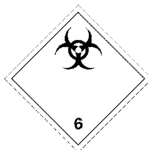
(Nr. 6.2) In der unteren Hälfte des Gefahrzettels darf angegeben sein: „ANSTECKUNGSGEFÄHRLICHE STOFFE“ und „BEI BESCHÄDIGUNG ODER FREIWERDEN UNVERZÜGLICH GESUNDHEITSBEHÖRDEN VERSTÄNDIGEN“; Symbol (Kreis, der von drei sichelförmigen Zeichen überlagert wird) und Angaben: schwarz auf weißem Grund; Ziffer „6“ in der unteren Ecke
