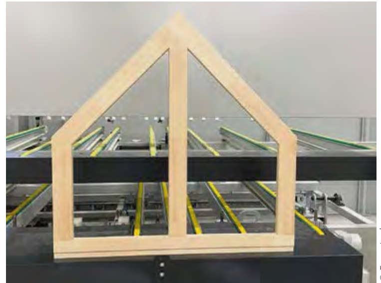
Ein Holzfenster, angefertigt mit der CNC-Maschine.
