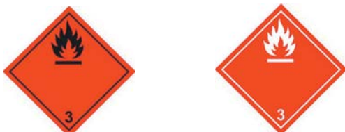
Abbildung 3: Gefahrzettel-Muster Nr. 3 nach dem Gefahrguttransportrecht, mit dem Maschinen und Geräte mit Kraft- oder Brennstofftanks gekennzeichnet sein müssen. Die Farben Schwarz oder Weiß können frei gewählt, dürfen aber nicht vermischt werden.
