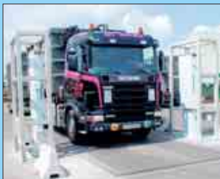
Lkw zwischen den beiden Detektorsäulen des YANTAR 2L
