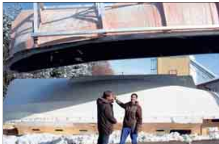
Das Negativ wird vom Schiffsmodell abgehoben.
