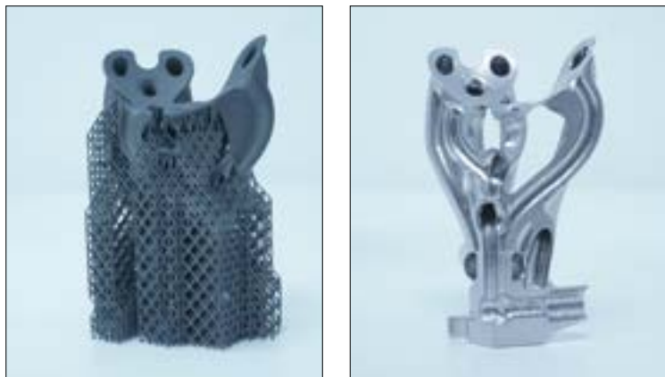
Ein 3D-Druckteil vor (links) und nach (rechts) dem „Hirtisieren®“.
