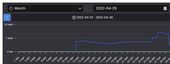
Messung Energieverbrauch eines Kühlgeräts
